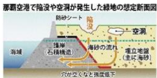
図 83 那覇空港で発生した陥没事故(沖縄タイムス2021年1月16日)
